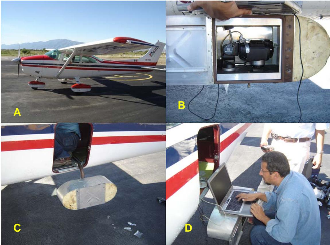
Figura 18. Vuelo en avioneta tipo Cessna 182. A) Avioneta, B) Equipo de fotografía, C) Caja con la cámara digital, D) Programando el software de captura de imagen con el GPS y con la cámara digital.
